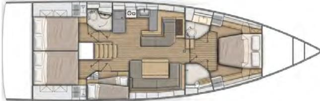
La salle d'eau tribord de la version standard est remplacée par une cabine avec lits superposés
