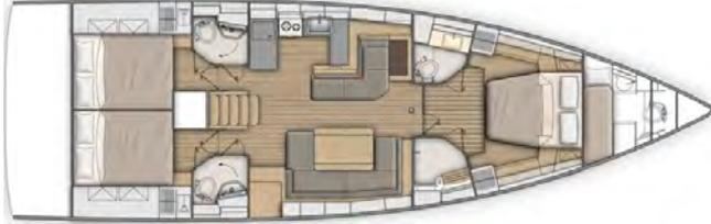
L'arrière cuisine passe à tribord et est remplacée par une salle d'eau. Les cabines arrière sont symétriques.
